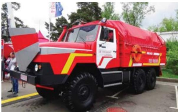
Рисунок 1 – Полифункциональные модификации ПА [1]: АЦ 3.0-40/4 (43253) – с отвалом (толкающее усилие – 3000 кг), гидроприводным кран-манипулятором и световой мачтой (рис. 1 а); водоплавающий пожарный автомобиль АЦ 4.0 (рис. 1 б)
