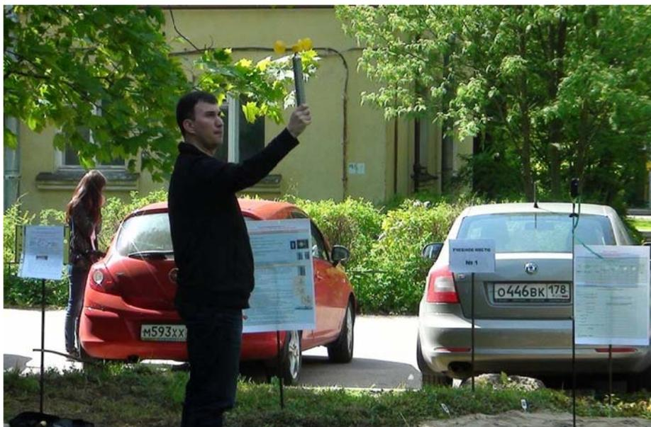
Рисунок 5 – Определение скорости воздуха метеокомплексом МК-3Бриз
