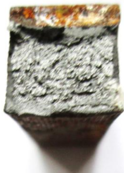
Рисунок 5 – Излом ударного образца: сталь 40Х, холодный прокат без газовой обработки
