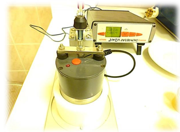
Рисунок 1 – Измерение активности воды образцов папоротника орляка с помощью прибора Robotronic HygroLab (снимок автора)
