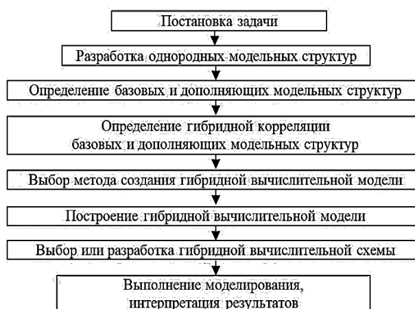
Рисунок 14 – Универсальная схема создания гибридных вычислительных моделей [3]
