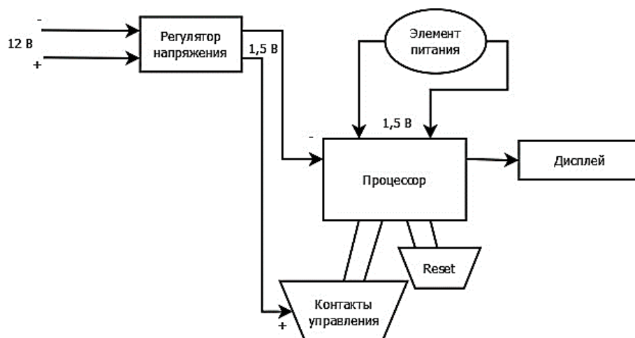
Рисунок 1 – Принципиальная схема датчика учета работы ТорС
