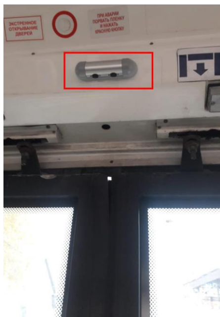
Рисунок 3 – Установленный счетчик пассажиропотока в салоне ТС
