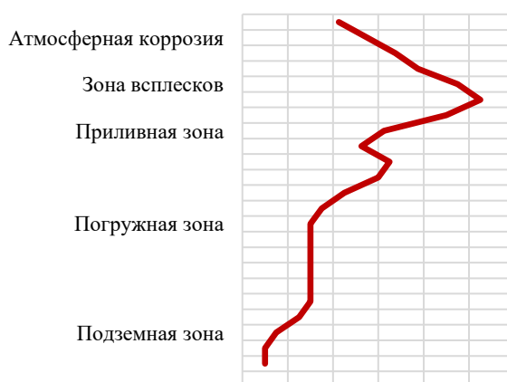
Рисунок 9 – Динамика потери металла стальными конструкциями от волнового воздействия
