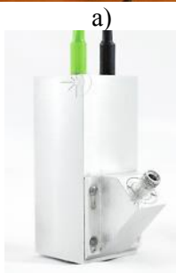
Рисунок 4 – Комплект средств лазерно-ультразвукового контроля: а) лазерно-ультразвуковой дефектоскоп; б) ОАП
