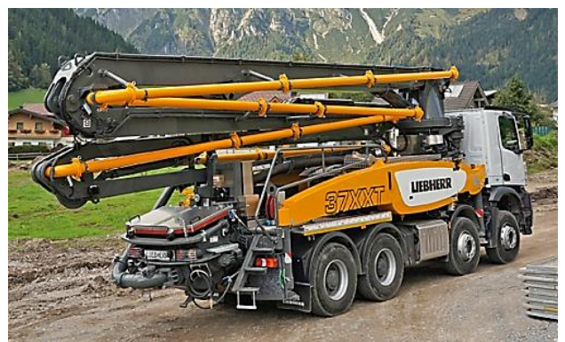
Рисунок 2 – Автобетононасос 37 Z4 ХХТ с 4-секционной распределительной мачтой [2]
