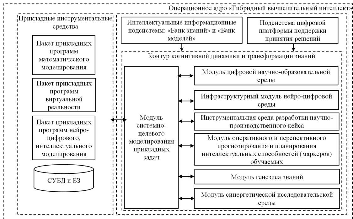
Рисунок 7 – Тестовый вариант архитектуры программно-технического комплекса инструментальной среды проектирования элементов нейро-цифровой научно-образовательной экосистемы
