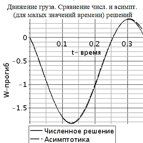
Рисунок 7 – Сравнение аналитического и численного метода Дурбина
