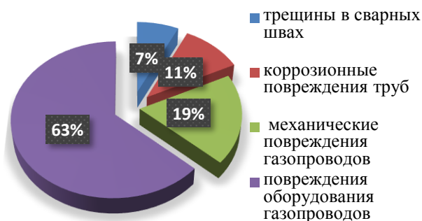
Рисунок 3 – Причины отказов в системах газораспределения [составлено по данным ООО «Газпром межрегионгаз»]
