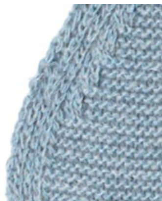
Рисунок 5 – Групповые сбавки петель при вывязывании контура рукава реглан
