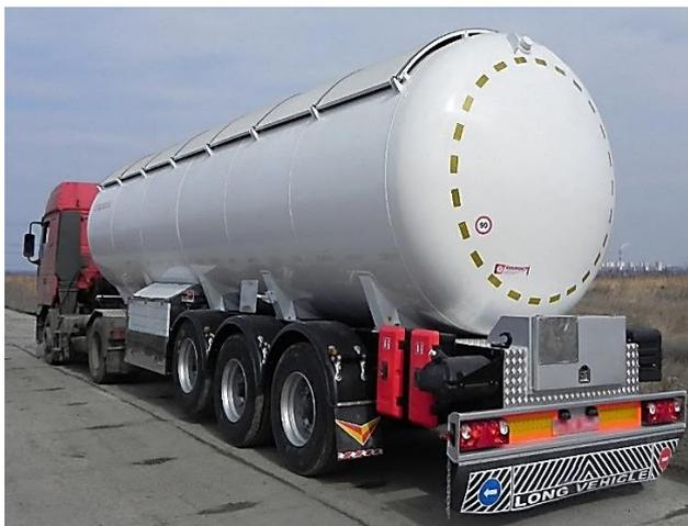
Рисунок 2 – Транспортировка автомобильным транспортом газа в цистерне
