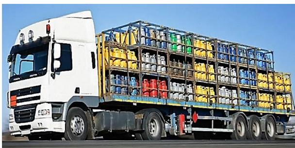
Рисунок 3 – Транспортировка автомобильным транспортом газа в баллонах
