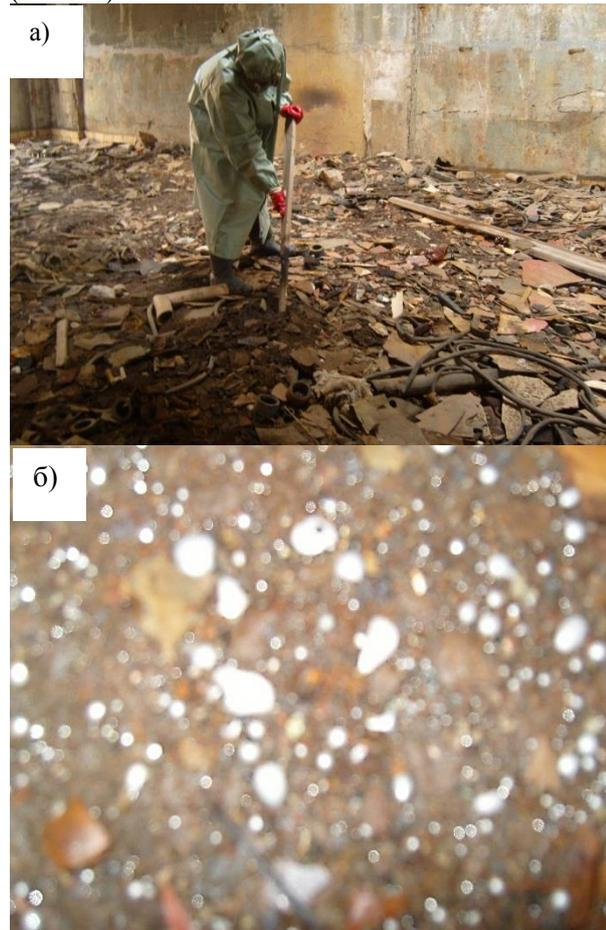
Рисунок 4 – Вид на один из участков разрушенного «хлорного» цеха (а). Производственный мусор не утилизируется с 1997 года и покрыт ртутными каплями и лужами (б), сентябрь, 2010 г.
