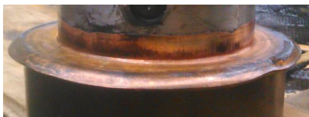
Рисунок 18 – Пластическая деформация медной прокладки при давлении P_{max} = 450 МПа
