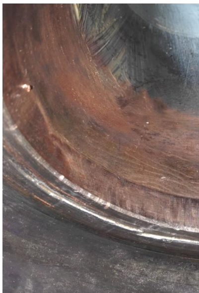
Рисунок 20 – Омеднение камеры при давлении P_{max} свыше 650 МПа
