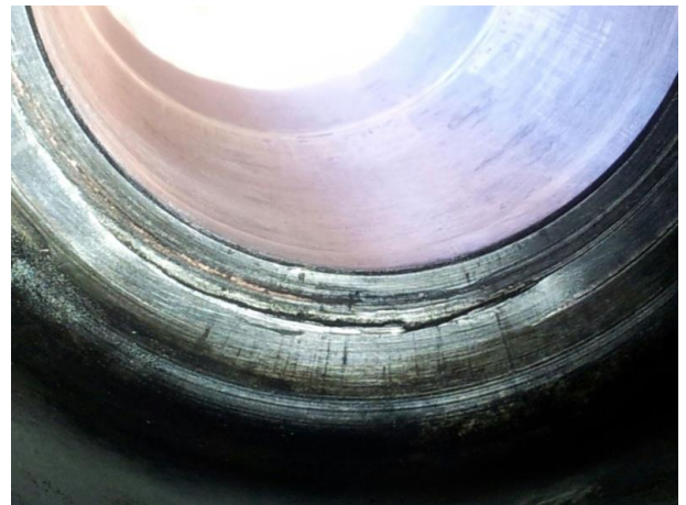
Рисунок 21 – Разрушение камеры по контактной площадке при давлении P_{max} свыше 650 МПа
