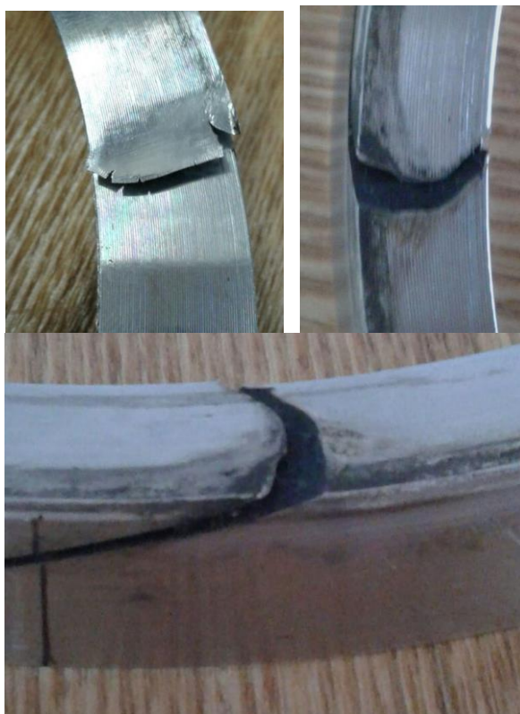
Рисунок 9 – Пластическая деформация и разрушение кромок переднего кольца после испытаний
