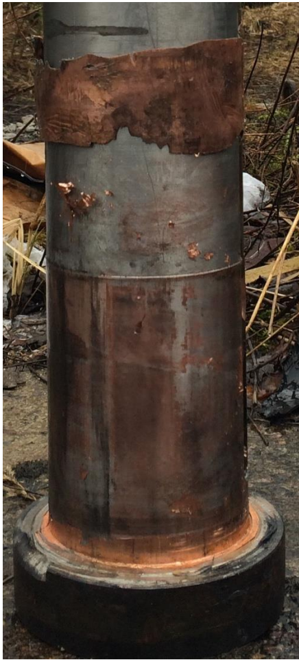
Рисунок 19 – Разрушение медной прокладки и ствола после выстрела при давлении P_{max} свыше 650 МПа
