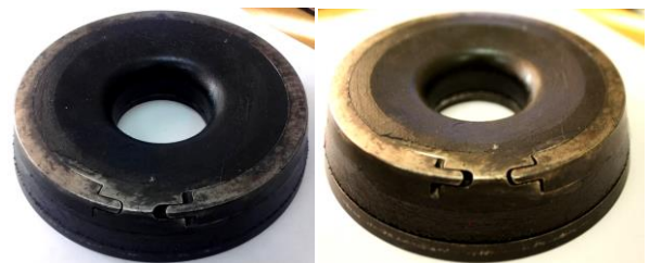
Рисунок 15 – Узлы обтюрации после испытаний при давлении P_{max} = 650 МПа
