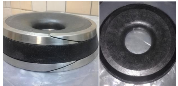
Рисунок 7 – Узлы обтюрации до испытаний
