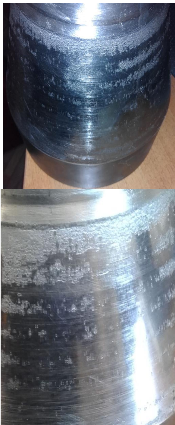
Рисунок 28 – Коническая поверхность ствола после упрочнения нагружением при давлении P_{max} = 900 МПа: а) ствол; б) камера. (имеются следы схватывания поверхностей в условиях пластических деформаций)
