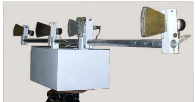
Рисунок 1 – Фотография растрового датчика
