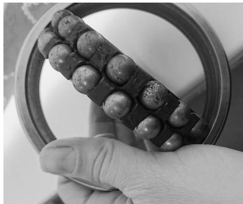
Рисунок 3 – Самоустанавливающийся шариковый подшипник
