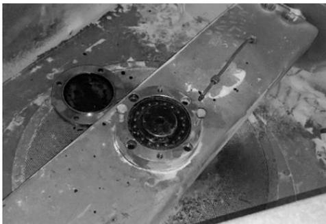
Рисунок 2 – Шариковый подшипник верхней опоры ротора
