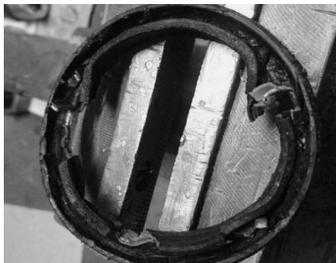
Рисунок 4 – Сальниковое уплотнение шарикового подшипника
