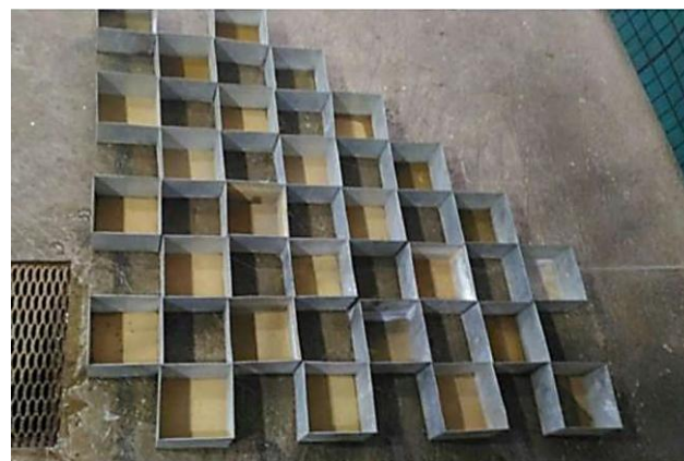
Рисунок 2 – Схема расположения мерных банок при испытании водяных оросителей
