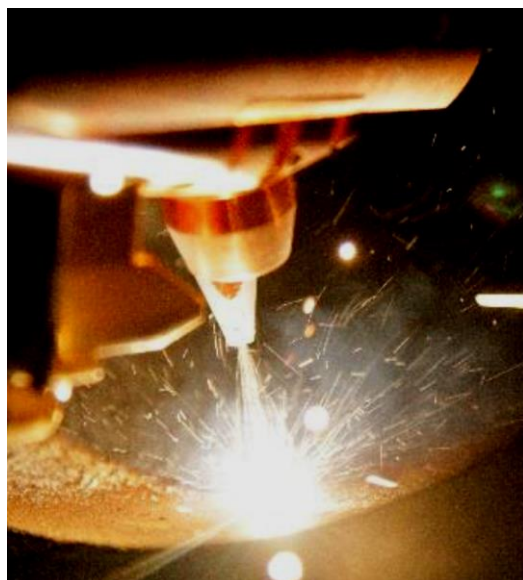
Рисунок 5 – Процесс лазерной наплавки на внутреннюю поверхность трубы: а) – внешний вид; б) – схема процесса
