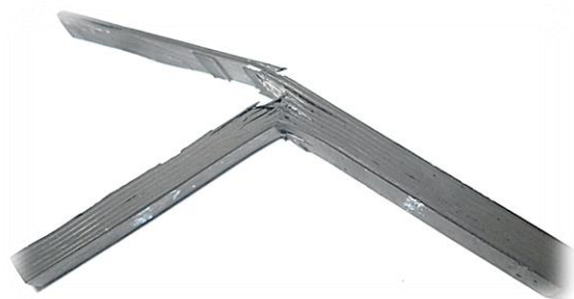
Рисунок 8 – КМУ-4Л: Обдув 2,5 минуты поперёк потока, перпендикулярно слоям. Направление удара совпадает с направлением обдува
