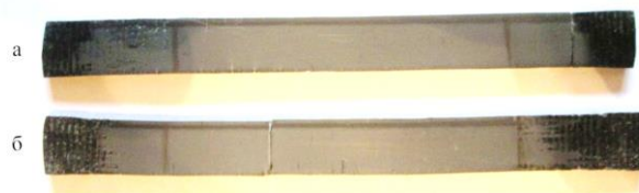
Рисунок 4 – Пластины из полистирола после испытаний на растяжение: а, – необдутая, б – подвергавшаяся воздействию пульсирующего воздушного потока
