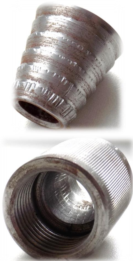
Рисунок 17 – Деформация конуса и гайки кабельного ввода после затяжки гайки и приложения осевой нагрузки
