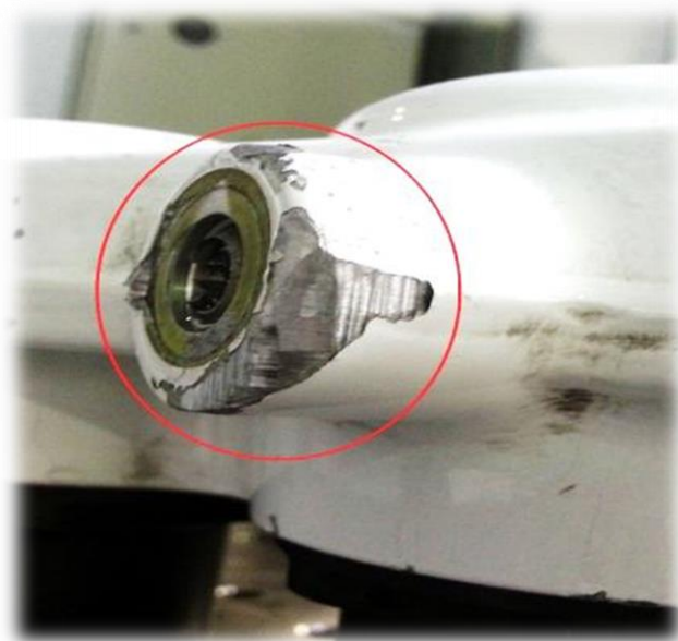
Рисунок 6 – Срез клапана подачи гидрожидкости в блок цилиндров тормозного устройства от резервной г/системы [10]
