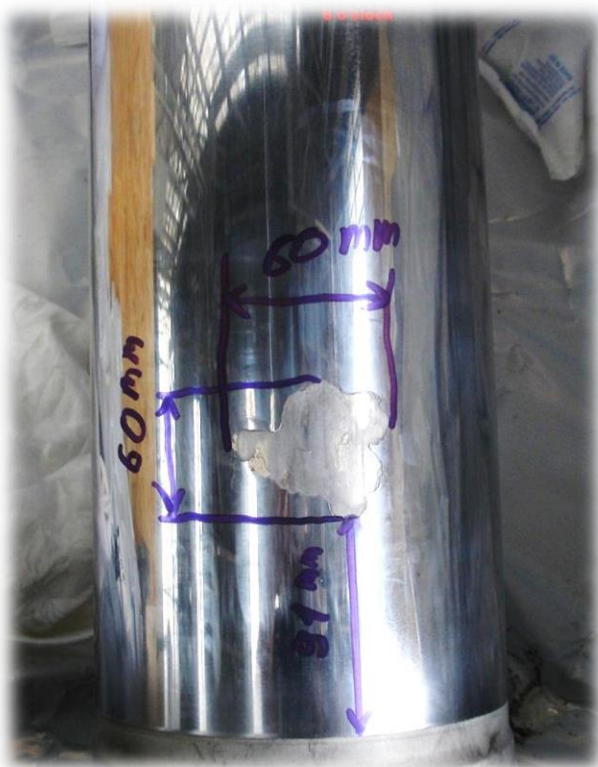
Рисунок 2 – Повреждение хромового покрытия на штоке амортизатора [9]
