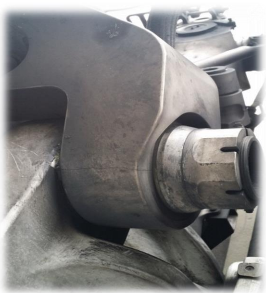
Рисунок 1 – Трещина в проушине нижнего звена шлиц-шарнира [9].
