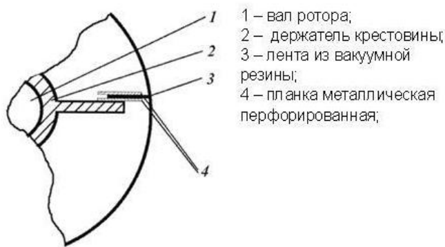
Рисунок 1 – Схема экспериментального скребкового устройства
