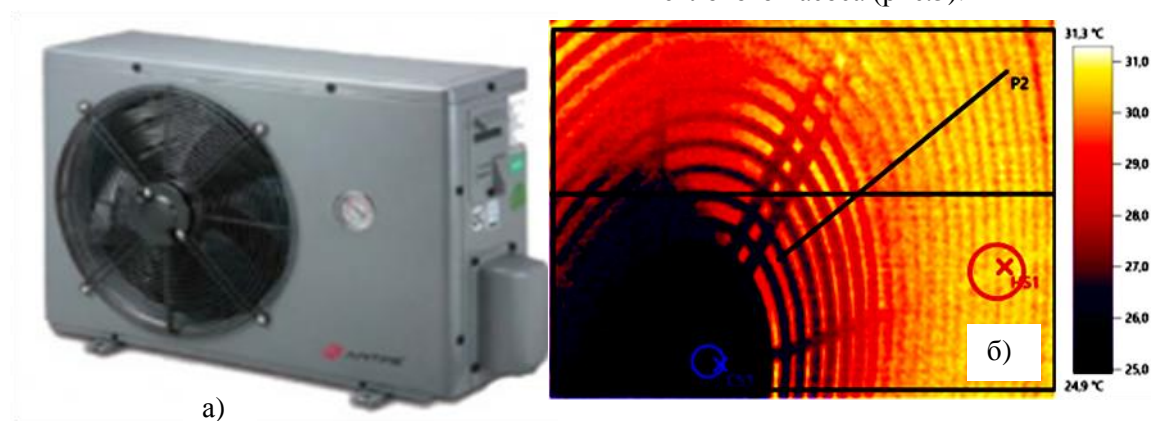
Рисунок 5 – Теплообменник теплового насоса: а) – внешний вид; б) – картина от тепловизора (коэффициент излучения: 0,94; отраж. темп. 27,0°C; самая холодная точка – +25,1°C; самая теплая точка – +31,3°C)
