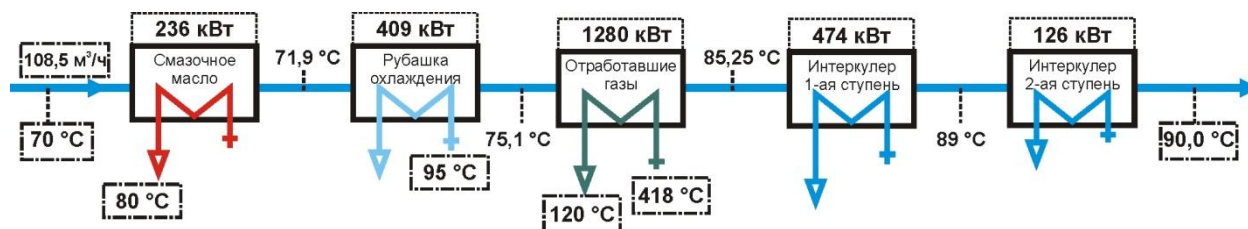
Рисунок 17 – Предлагаемая схема утилизационного модуля когенерационной установки JMS-616 GS-N.L
