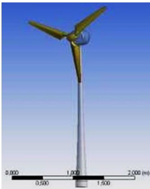
Рисунок 1 – Геометрия модели однороторной ВЭУ в ANSYS DesignModeler
