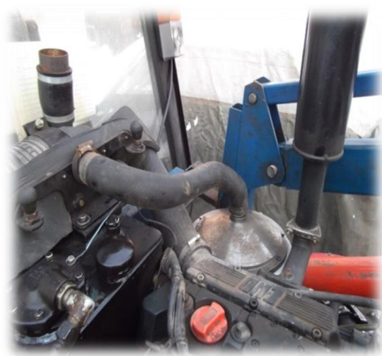
Рисунок 3 – Расположение теплового аккумулятора фазового перехода на двигателе испытательного трактора
