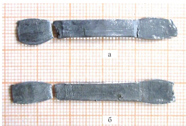
Рисунок 2 – Свинцовые пластины после испытаний: а – без обработки, б – с газоимпульсной обработкой
