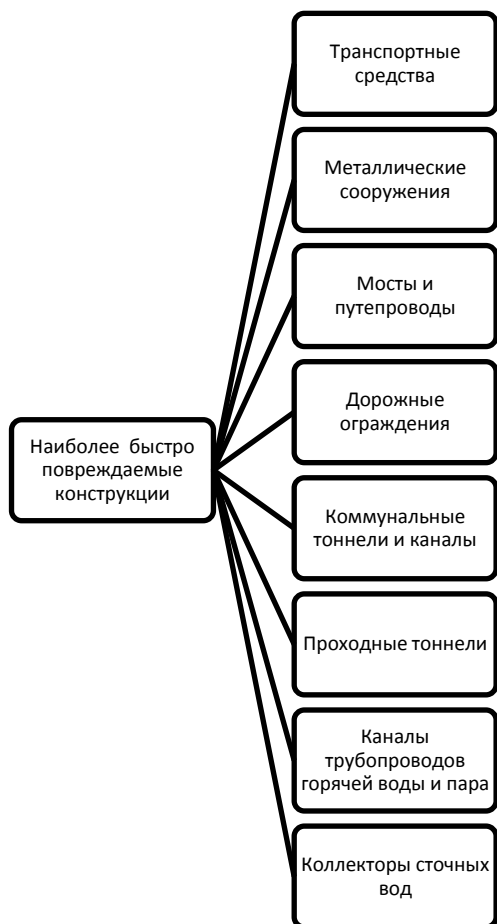
Рисунок 1 – Наиболее быстро повреждаемые металлические конструкции
