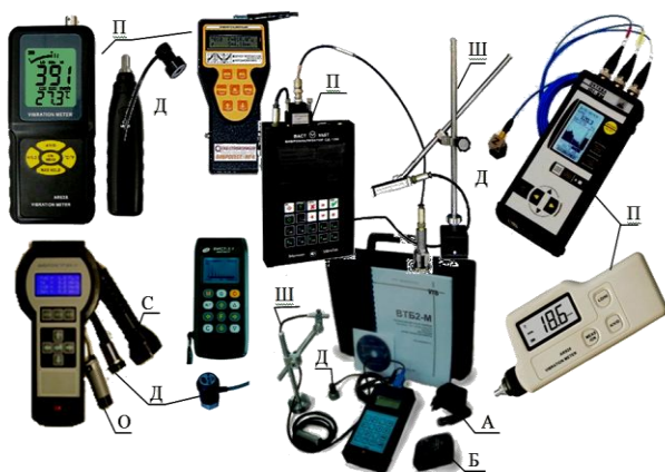
Рисунок 5 – Малогабаритные измерители вибрации: А – сетевой адаптер (зарядное устройство); Б – аккумуляторная батарея; П – прибор; Д – датчик вибрации; С – стробоскоп; О – оптический датчик; Ш – установочная шпилька с магнитным держателем
