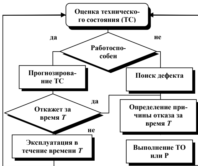
Рисунок 2 – Оценка технического состояния и реализация ТО
