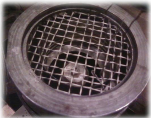
Рисунок 7 – Кольцо, зафиксированное проволочной сеткой, размещено непосредственно возле рассекателя и взаимодействующей с ним веерной струи
