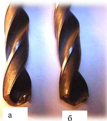
Рисунок 3 – Износ передней поверхности режущей кромки сверла из 9ХС: а – необработанного; б – обработанного пульсирующим дозвуковым газовым потоком
