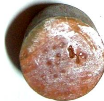
Рисунок 3 – Образцы из стали 12ХН после пребывания в 4%-м водном растворе HCl продолжительностью 15 суток: а) – состояние поставки; б) – газоимпульсная обработка
