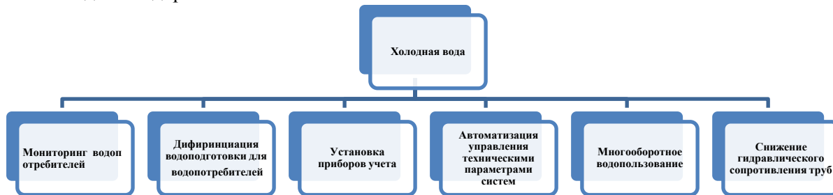
Рисунок 2. – Общая структура технических мероприятий по повышению энергоэффективности систем холодного водоснабжения и водоотведения
