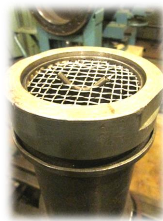
Рисунок 1 – Упругоизогнутая стальная витая пружина размещена на выходе из успокоительной камеры установки
