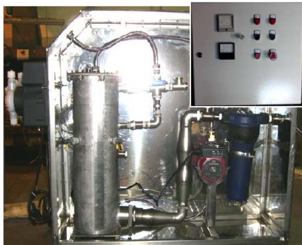
Рисунок 2 – Опытная установка электрореагентной очистки воды
