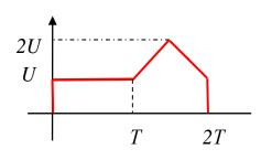
2. Как с помощью трех фильтров, согласованных с прямоугольными импульсами, длительность которых можно изменять, и сумматора, построить фильтр, согласованный с сигналом приведенный на рисунке.
